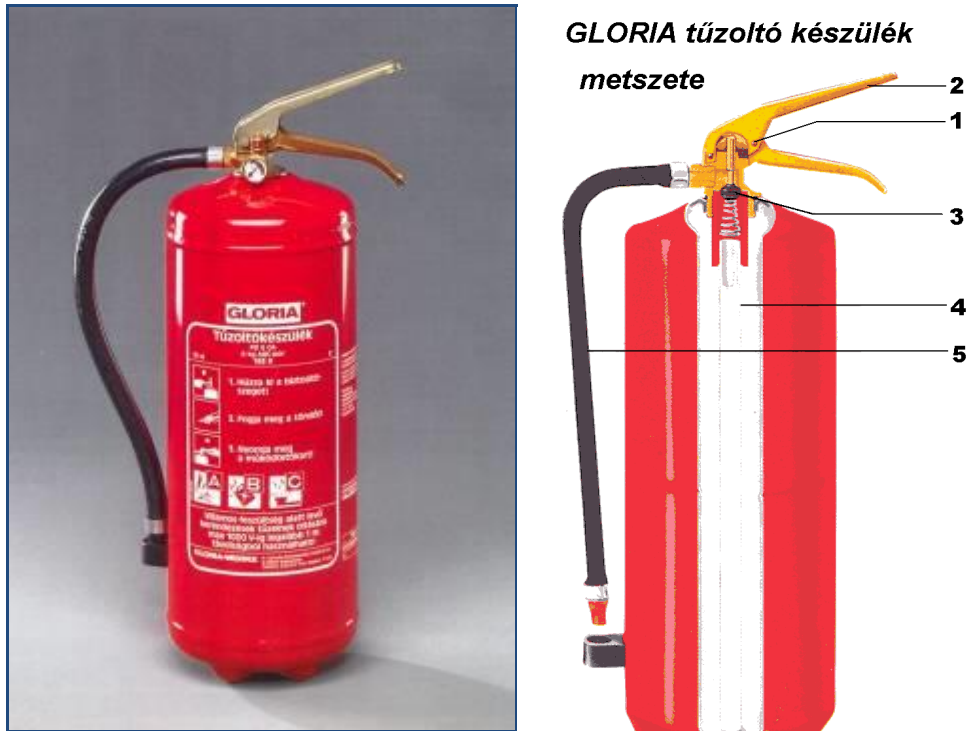
2.19. ábra PD 6 GA állandó nyomású porral oltó tűzoltó készülék fényképe és metszeti ábrája: 1. biztosítószeg, 2. működtető kar, 3. szelepszár, 4. felszállító cső, 5. tömlő a lövőkével;
