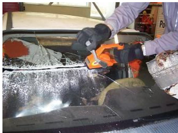
5.7. ábra A ragasztott szélvédők vágó készüléke
