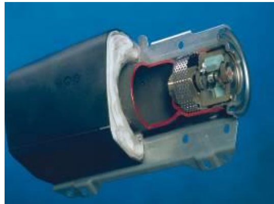
5.15. ábra Kormánykerékbe épített Air-Bag részei
