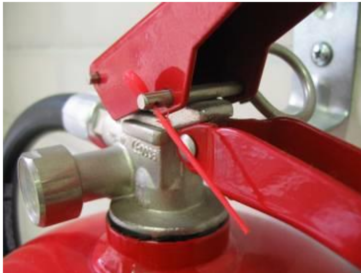
2.12. ábra Állandó nyomású tűzoltó készülék nyomómarkolatos indítószerelvénnyel, mely a szakaszos működtetést is lehetővé teszi, nyomásmérővel, tömlő csatlakozással és a véletlen működést megakadályozó plombált biztosítószeggel
